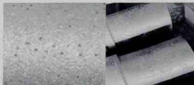
图1 铸件上的麻点缺陷
