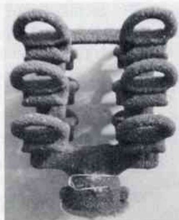
图4 第三层使用石墨砂后的型壳表面状态
